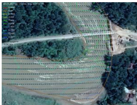
Gambar 5. Pola kecepatan arus pada jembatan air enim 3 kondisi Eksisting
