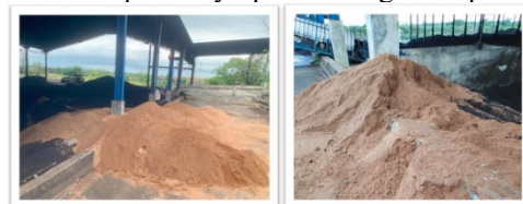
Gambar. Penyimpanan serbuk kayu untuk Cofiring di PLTU Asam Asam
