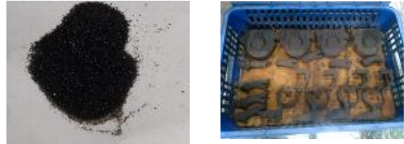
Gambar 11 Sand Mold dibuat dari Oasir Bauxite
