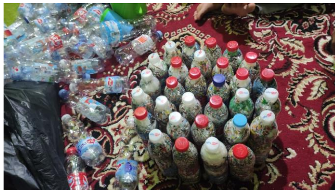
Gambar 1. Botol plastik bekas yang telah diisi dan dipadatkan dengan sampah plastik
