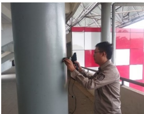
Gambar 2. Cara Pelaksanaan Pengukuran Kekuatan Struktur Kolom dengan Alat UPV
