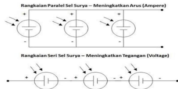
**Gambar 2.** Rangkaian Seri dan Paralel Sel Surya
