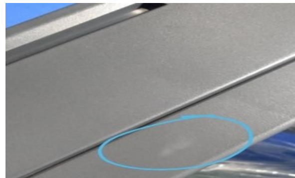
Gambar 4. Defect Gas Mark pada housing panel
