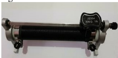
Gambar 13. Rheostat J2354 dengan kapasitor 300 Ω-1A
